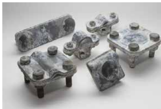
Рис. 2. Гарячеоцинкована продукція «Leo Lightman» після випробування на корозійну стійкість
