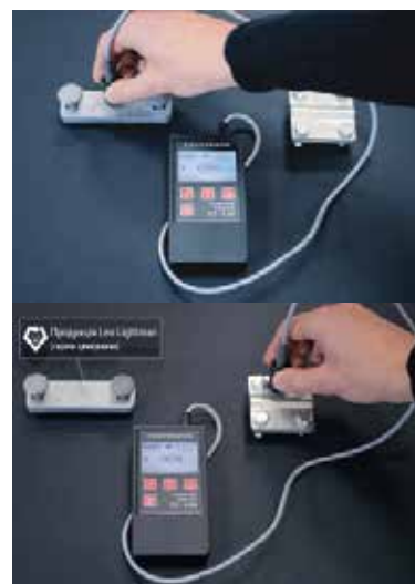
Рис. 4. Вимірювання товщини цинкового покриття. Гальванічне цинкування – 5 мкм. Гарячеоцинкована продукція «Leo Lightman» – 50 мкм.
